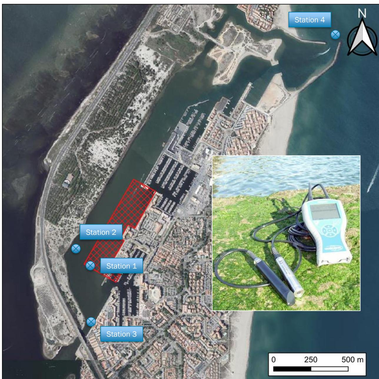
Figure 67 : Localisation des stations de suivi de la turbidité – Les stations 1 et 2 sont déplacées au fur et à mesure de la progression des travaux. Exemple de sonde turbidimètre pour mesurer *in-situ* la turbidité de l'eau.
