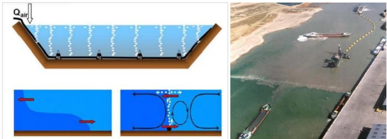
Figure 58 : Principe de fonctionnement d'un rideau à bulles (GEODE)
