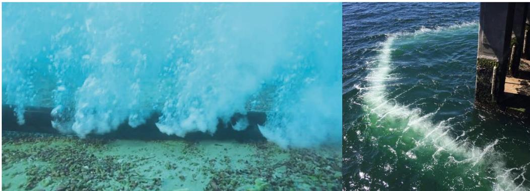
Figure 62 : Illustration de la mise en œuvre d'un rideau de bulles (vue depuis le fond à gauche, et de la surface à droite)
